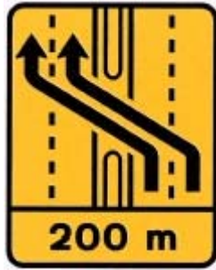
ST5 – Desvio para a faixa de rodagem contrária
