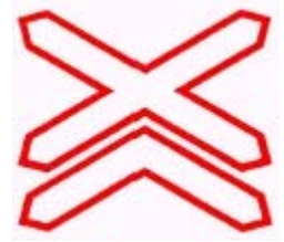
A32b - Local de passagem de nível sem guarda com duas ou mais vias
