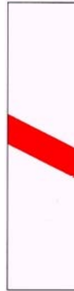
I9f – Aproximação de passagem de nível
