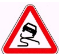
A5 – Pavimento escorregadio
