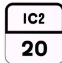
O3c – Demarcação miriámetrica da via – IC
