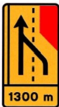
ST2 – Supressão de via de trânsito
