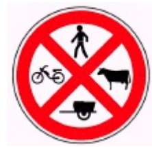
C4e - Trânsito proibido a peões, a animais e a veículos que não sejam automóveis ou motociclos
