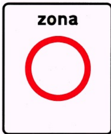
G5a - Zona de trânsito proibido
