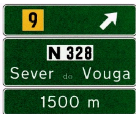
I1 – Pré-aviso simplificado (Intersecção desnivelada)
