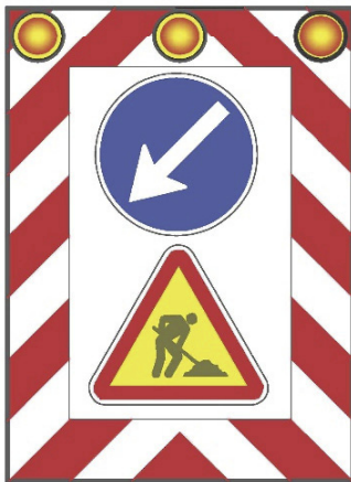
ET12 - Atrilado de balizamento
