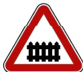
A26-Passagem de nível com guarda
