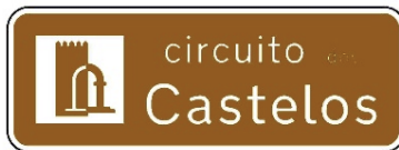
T4a-Identificação de circuito
