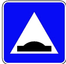
H48—Lomba redutora de velocidade
