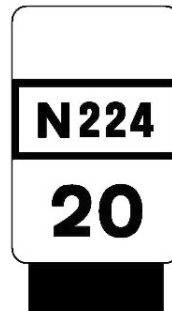
03d—Demarcação miriámetrica da via – restantes estradas
