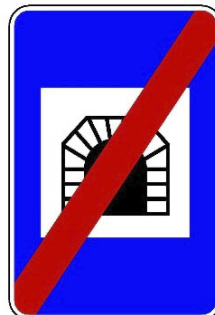
H41—Fim de túnel
